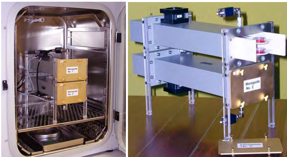
Abbildung 2.2: Expositionskammern des Systems für GSM1800MHz Befeldung (links, bereits im Inkubator aufgestellt) und für UMTS (1950 MHz) Befeldung (rechts, mit noch geöffnetem oberem Wellenleiter und dadurch erkennbaren Petri Schalen)
